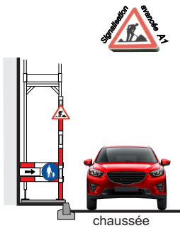
E 4 Fermeture du trottoir (déviation des piétons sur trottoir adjacent)
